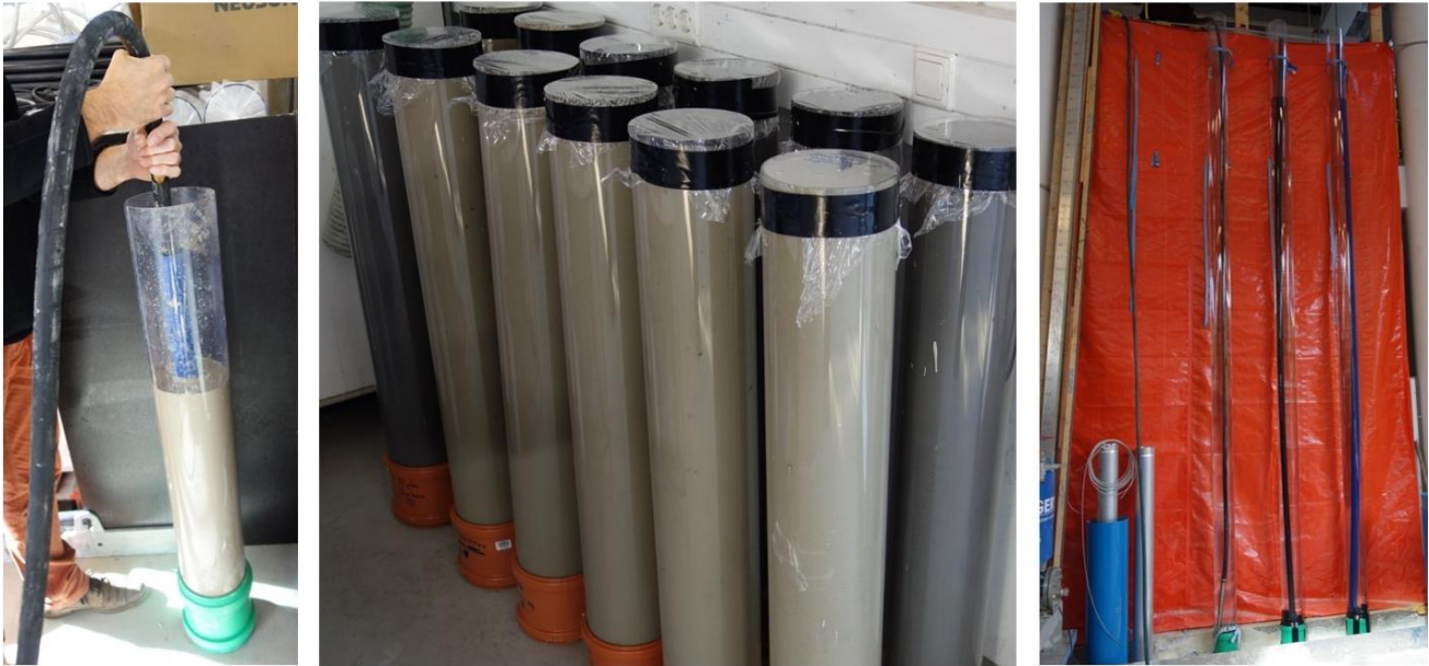
Abb. 6: links: Hochfrequenz-Innenrüttler in PE-Sondenrohr der Maße 40 x 3,7 mm; Mitte: Vorversuche zur Rütteltechnik in 1 m hohen transparenten Rohren; rechts: Technikumsversuche zur Rütteltechnik in 5 m hohen transparenten Rohren.
